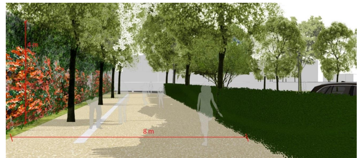
Vue perspective de l'espace piétonnier longeant l'école Daudet. Sur la gauche, l'écran antibruit doté de végétation grimpante. Le trottoir a une largeur de 8 m, l'écran antibruit une hauteur de 4 m.
